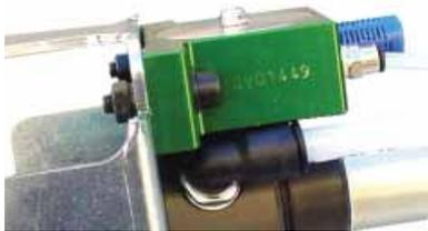
Verificare il buon funzionamento del vibratore pneumatico situato nel bocchettone di aspirazione. Assicurarsi che vibri e che la vibrazione sia quella adeguata.
