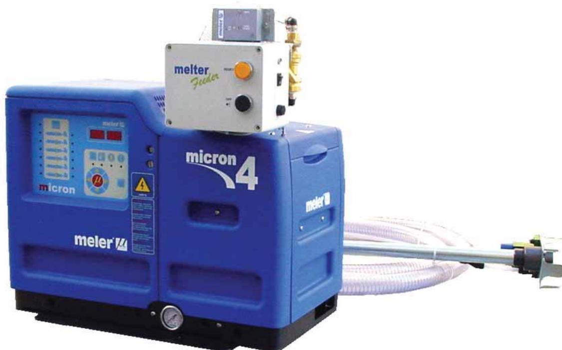
Un sistema di allarme, temporizzato dal momento dell'individuazione del livello basso, annuncia possibili anomalie nel caricamento o nello svuotamento completo del contenitore per il suo rifornimento.
