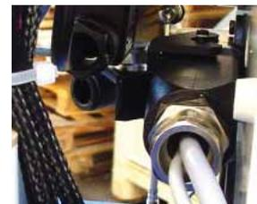
Entrambi i sensori vanno collegati via cavo a uno stesso connettore che si collega alla scatola di controllo. Questa connessione permette l'installazione della scatola di controllo al di fuori dell'ubicazione sul apparecchio di fusione, mediante un cavo di interconnessione della lunghezza necessaria.
